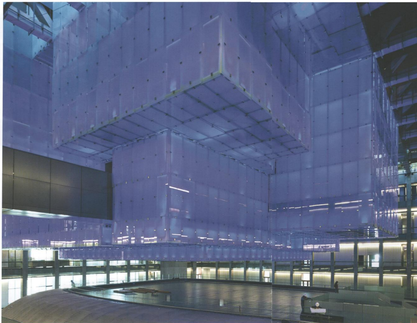
Una suerte de "chandelier contemporáneo" alberga salas temáticas dentro de una estructura acristalada de 2.000 toneladas, sostenida con un marco de vigas Vierendeel e iluminada en varios tonos cambiantes.
