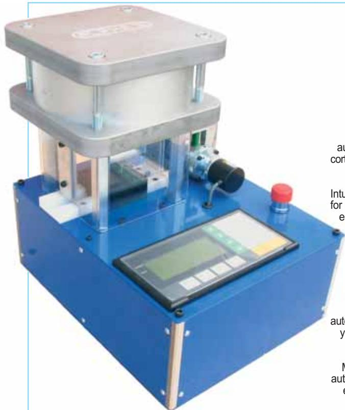
Máquina intuitiva e totalmente automática de medir, mecanizar e cortar barra de cremona em poliamida e alumínio; para CE.
